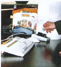
Bild 4: Das kleine Lesegerät braucht wenig Platz an der Rezeption und schont gleichzeitig die Karte.
